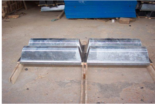
Figura 2- Moldes metálico (cumbucas) para lajes nervuradas. Fonte: REDUZCON..
